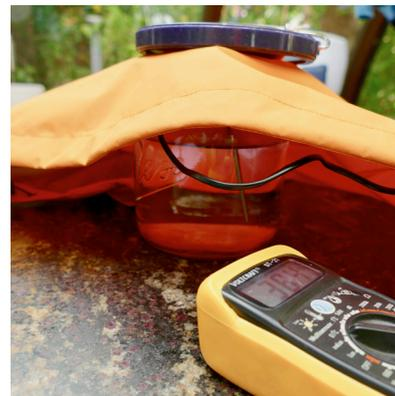
Der Test wurde bei einer Raumtemperatur von 24°C durchgeführt, was die Membranen in etwa in die Nähe der Leistungsfähigkeit bringt, denn der Temperaturunterschied betrug beim Versuch etwa 14°C.
