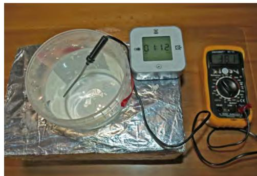
Der Test wurde bei einer Raumtemperatur von 21°C durchgeführt, was die Membranen nur in etwa in die Nähe der Leistungsfähigkeit bringt, denn der Temperaturunterschied betrug beim Versuch 17°C.
